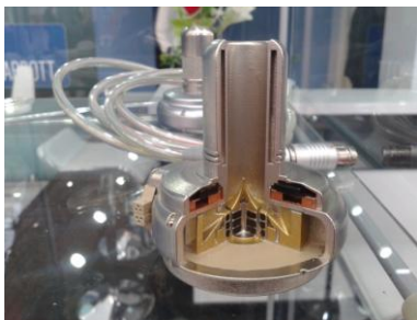
Obr. 13 Řez čerpadlem HeartWare III
