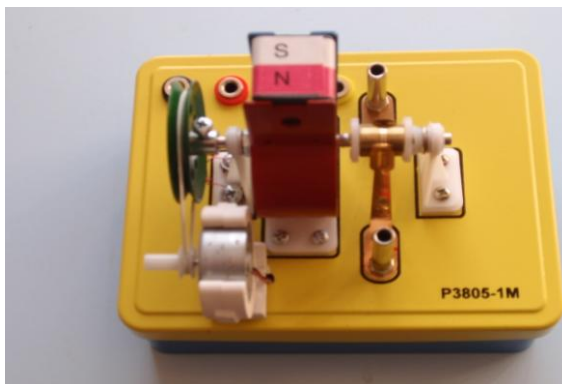
Obr. 13 Spřažené motorky na jedné ose pro měření otáček tachodynamem
