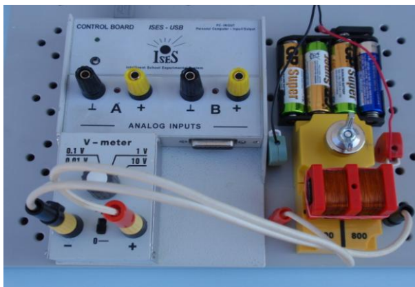
Obr. 15 Rotující magnet, cívka jako snímač
