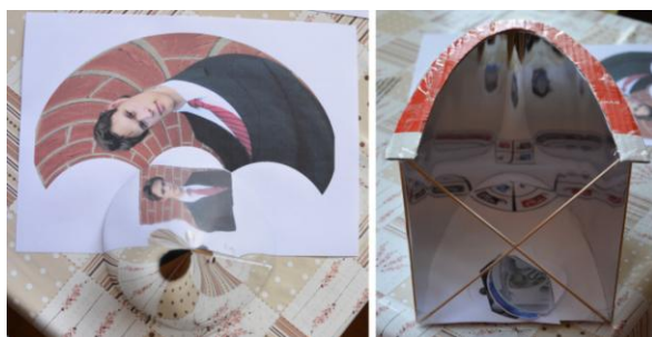
Obr. 4 Ukázka obrazu v kuželovém a v parabolickém zrcadle
