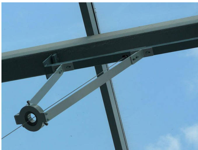
Obr. 2 Charronův prstenec kyvadla v prostorách schodiště PřF UP
