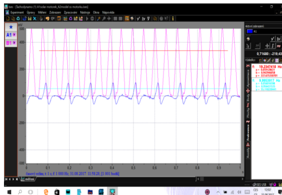
Obr. 14 A1 otáčky solárního motorku, B1 otáčky ss motorku
