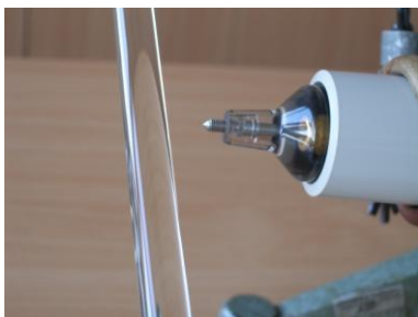
Obr. 4 Sršení náboje z nabitě skleněné tyče do hrotu sondy
